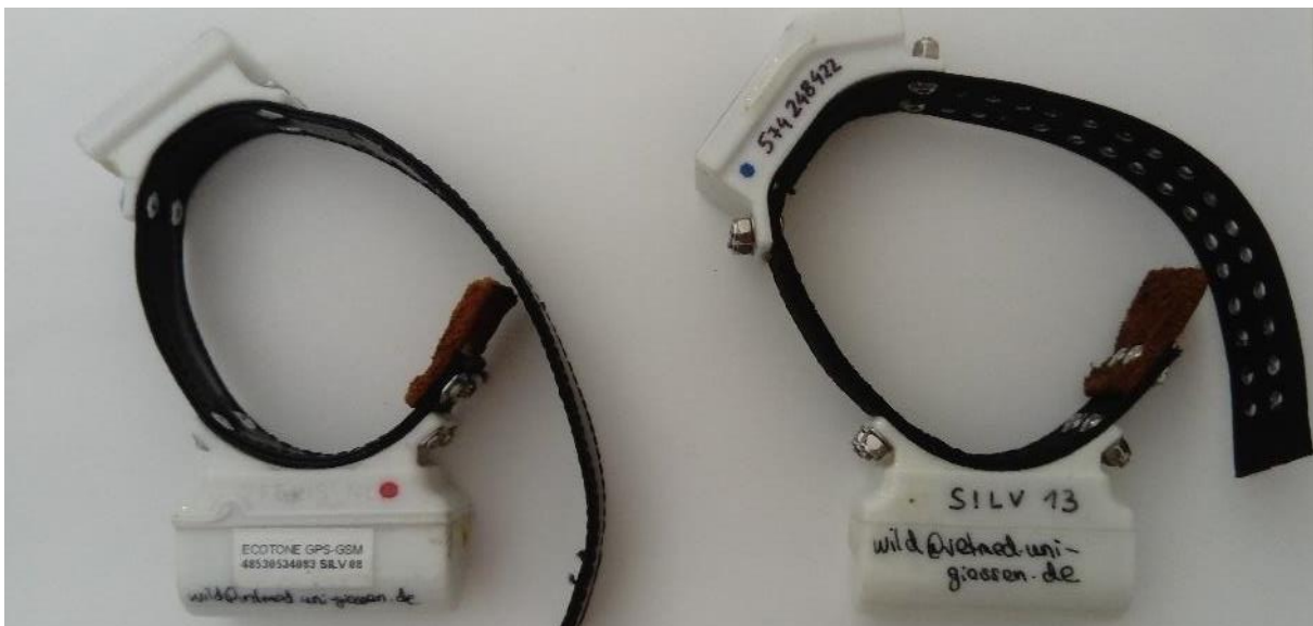
Abbildung 11: GPS-Halsband (84 g) der Firma ECOTONE TELEMETRY (Polen) mit Solarpanel und nachträglich hinzugefügter Sollbruchstelle. links: 1. Generation, rechts: 2. Generation. Foto: AG Wildtierforschung.
